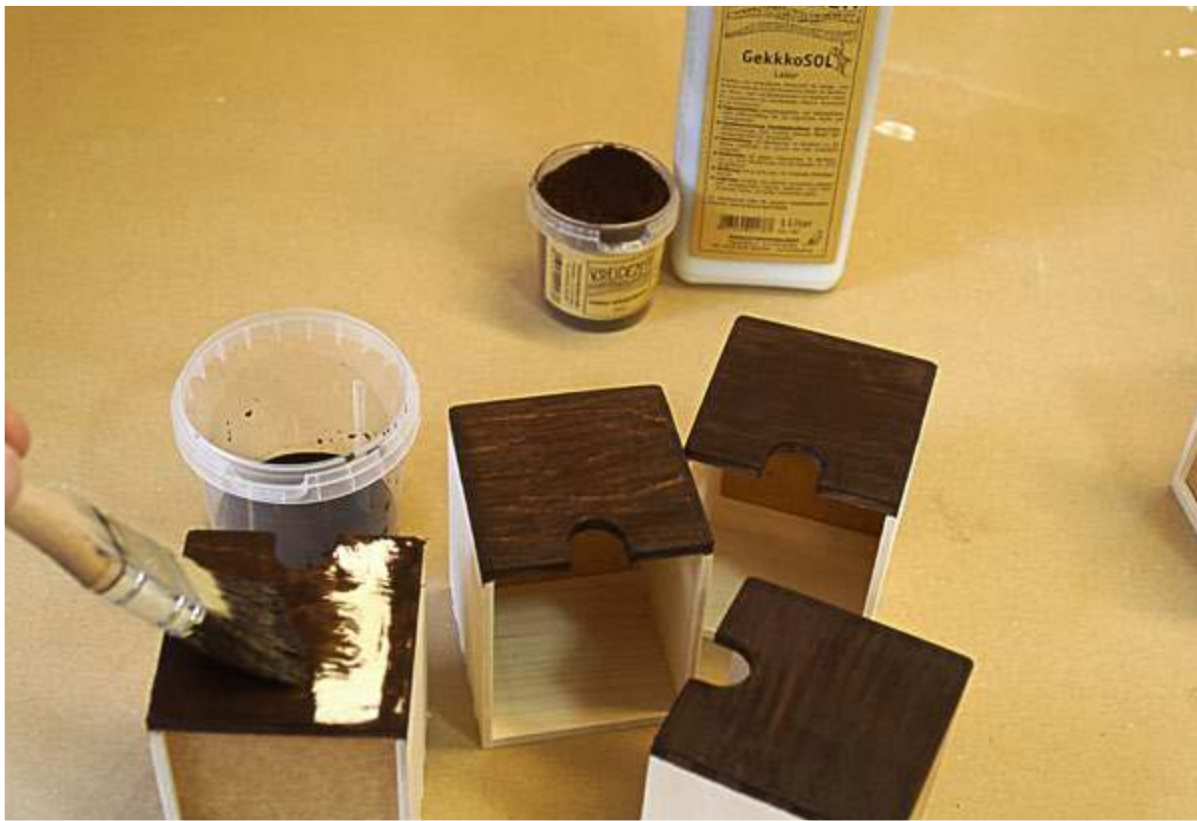
2. Grundieren mit GekkoSOL Lasur + Pigment Umbra schwarzbraun
