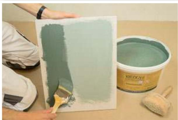
8. Pigmente in Kreidezeit Wandfarben und Putzen hellen erheblich während des Trocknens auf. Links, frisch aufgetragene Farbe, rechts getrocknete Farbe in derselben Pigmentierung.
