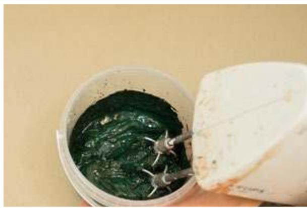
3. Pigmente mit einem Handrührgerät oder einem Rührholz klümpchenfrei vermengen, bis die Pigmentmischung zähflüssig ist.
